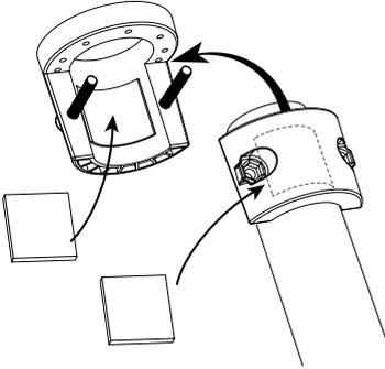
3. Coloque el conjunto de sensores sobre el poste de montaje y alinéelo en dirección norte antes de fijar los tornillos.
