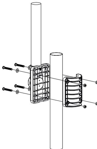
2. Aplique 2 almohadillas de goma en los lados interiores de la base de montaje y la abrazadera del conjunto de sensores y fíjelas sin apretar.
