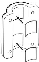
1c. Fije el soporte de montaje y la abrazadera a un poste fijo con 4 tornillos largos y tuercas.
