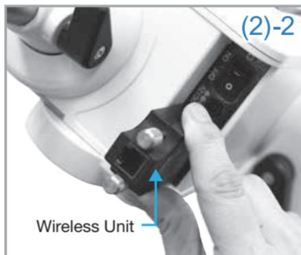
Achten Sie darauf, dass Sie zuerst die Wireless Unit anbringen, bevor Sie das Netzkabel anschließen. Die Wireless Unit kann brechen, wenn Sie sie aufsetzen, während die äquatoriale Montierung eingeschaltet ist. Damit wird ein Missgeschick bei der Einrichtung in dunkler Umgebung vermieden, wo es schwierig ist, die Position des Netzschalters zu überprüfen.
